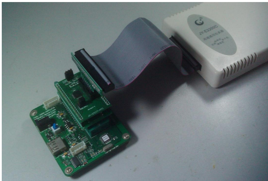
图 5-8 仿真头与仿真器连好经转换座插入用户板
