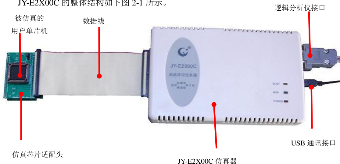
图 2-1 JY-E2X00C 的整体结构图
